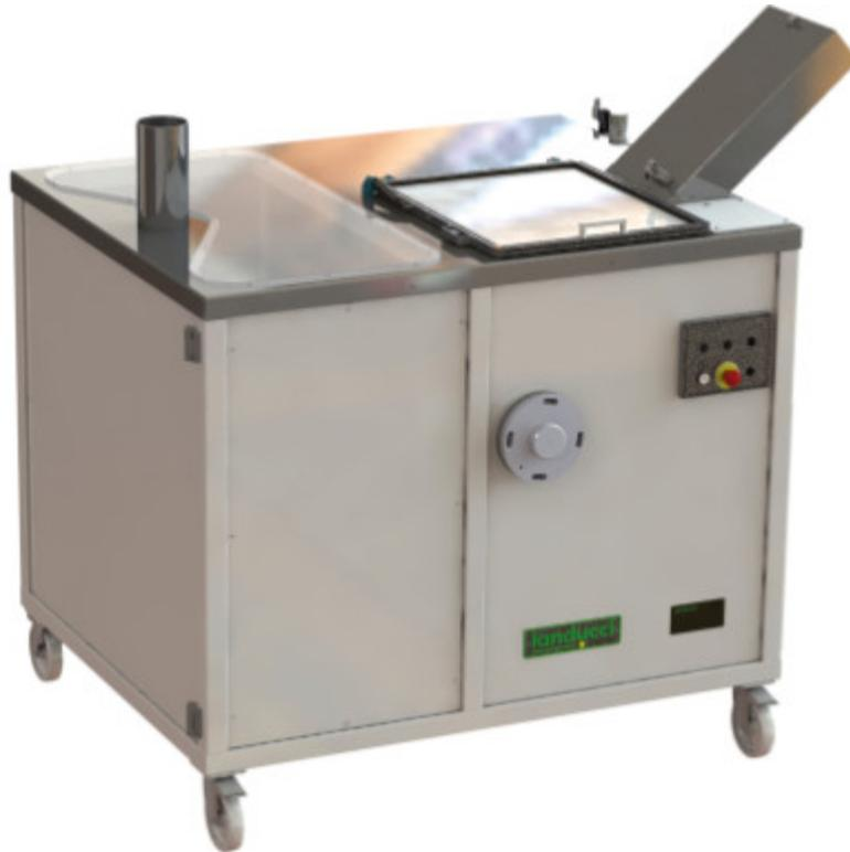
La macchina SRS-1, in combinazione con un sistema di triturazione, tubazione e ciclone, consente di reintrodurre direttamente nell'impastatrice gli scarti di pasta fresca derivanti dallo spurgo della testata e dai cambi formato, permettendone così il riutilizzo.
