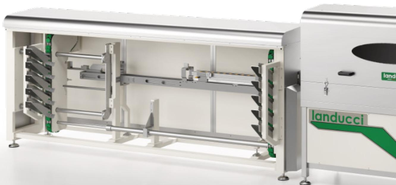
La macchina lavacanne Landucci è la soluzione completa per il lavaggio e sanificazione delle canne per il trasporto della pasta lunga (inclusi i ganci laterali) che si possono sporcare durante il processo di produzione.
